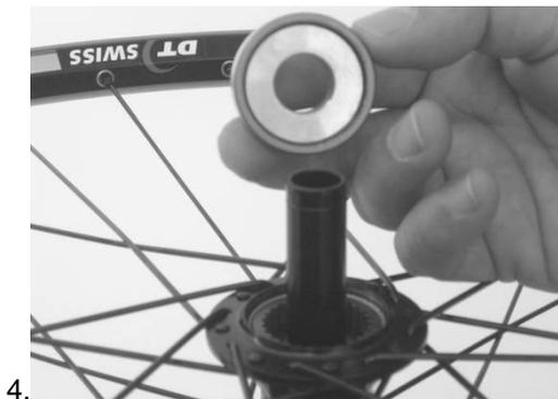
3. Die Dichtung auf das Montagewerkzeug für die Rotordichtung montieren.
