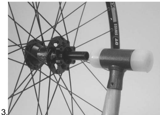
1. Achse mit Hilfe eines Kunststoffhammers aus dem Gehäuse herausschlagen.
