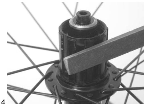
1. Lockring mit Zahnkranzabnehmer lösen.
