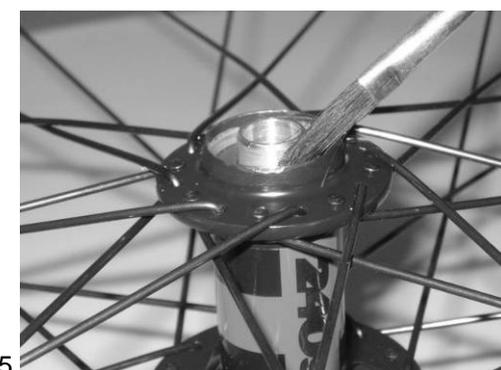
5. Endanschlätze gut reinigen und einfetten (handelsübliches Mehrzweckfett verwenden). Beide Endanschlätze auf die Achse stecken und von Hand aufdrücken.
