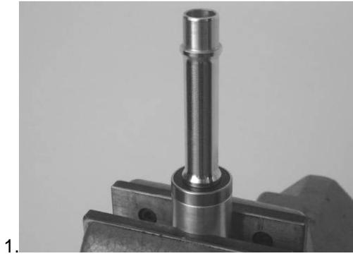
1. Kurze Montagebuchse in den Schraubstock spannen. Neues Kugellager 6902 (Ø15/28x7mm) mit Vorderradachse Disc Brake in die Buchse schieben.
