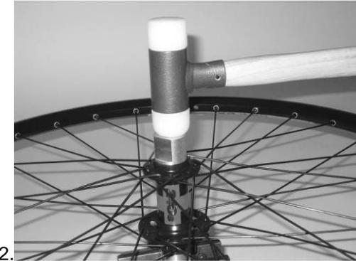
2. Zuerst Laufrad mit Disc Brake Seite über die Achse schieben. Mit zweitem Montagewerkzeug auf der Gegenseite die Achse zentrieren und mit dem Kunststoffhammer das erste Kugellager einpressen.
