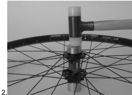
2. Zuerst Laufrad mit Disc Brake Seite über die Achse schieben. Mit zweitem Montagewerkzeug auf der Gegenseite die Achse zentrieren und mit dem Kunststoffhammer das erste Kugellager einpressen.
