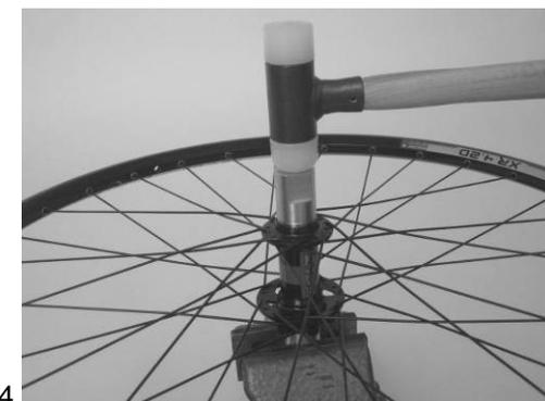
4. Mit Hilfe eines Kunststoffhammers zweite Kugellager einpressen.
