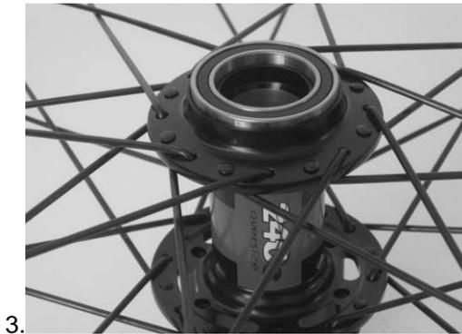
3. Achse zur Zentrierung ein wenig nach Oben ziehen. Zweites Kugellager 6805 ( $\text{\O}25/37\times7\text{mm}$ ) leicht ins in das Gehäuse drücken und zweite Montagebuchse darauf stecken. Nun mit Kunststoffhammer das Kugellager einpressen.
