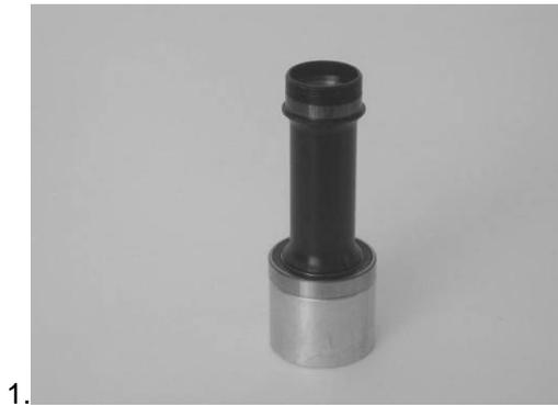
1. Kugellager 6805 ( $\text{\O}25/37\times7\text{mm}$ ) und VR Montagewerkzeug für Kugellager auf die Achse schieben.
