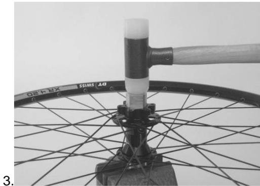
3. Das Laufrad mit der Antriebsseite auf die Achse stecken. Die zweite kurze Montagebuchse auf der gegenüberliegenden Seite auf die Achse schieben. Mit Hilfe des Kunststoffhammers das Kugellager einpressen.
