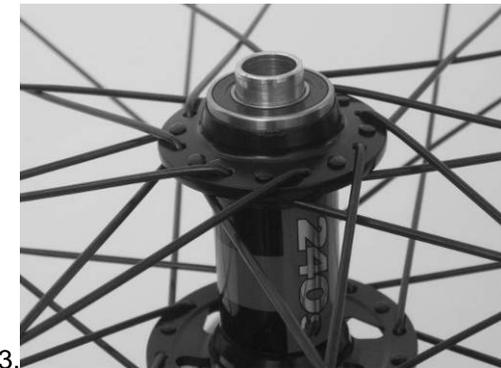
3. Achse zur Zentrierung ein wenig nach Oben ziehen. Zweites Kugellager 6902 (Ø15/28x7mm) leicht ins in das Gehäuse drücken und zweite Montagebuchse darauf stecken.
